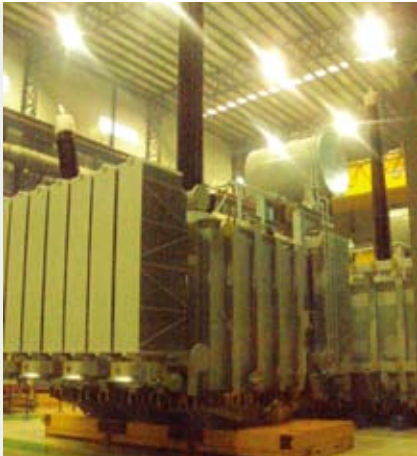
阿尔斯通——出口哥伦比亚 ODFSZ-150MVA/500KV ALSTOM-export to Columbia ODFSZ-150MVA/500KV
